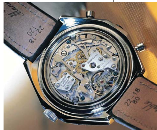
Automatikchronograph von 1969: Kaliber 11 mit Mikrorotor unter der Chronographen-Kadratur
